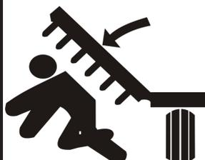
Para evitar acidentes, fique longe do equipamento quando o mesmo estiver articulando ou desarticulando. Falhas mecânicas ou hidráulicas podem fazer com que o equipamento abaixe rapidamente.
