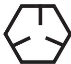
Cabeza del tornillo con grado 5 tiene tres marcas
