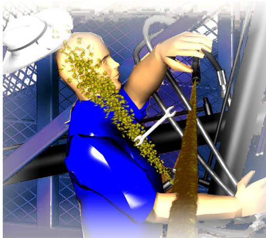
Antes de aplicar presión en el sistema, averigüe de que todos los componentes estén seguros y que las mangueras y los acoples no estén dañados.
