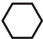
Cabeza del tornillo con grado 2 no tiene marcas
