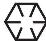
Cabeza del tornillo con grado 8 tiene seis marcas
